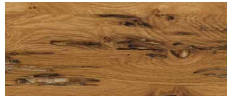
galeries creusées dans le bois par les moulés
