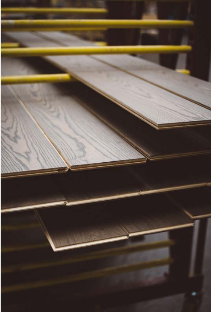
mafi verwendet hochwertige Dielenkonstruktionen im symmetrischen 3-Schicht-Aufbau für optimale Stabilität. ©mafi
